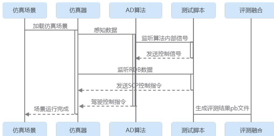
如上图所述，测试脚本能同时监听RDB和AD算法的内部数据，如通过RDB判断主车与前车距离小于20m，可发送某个控制信号给算法改变esp状态，也可以通过SCP指令控制场景中的副车改变运动姿态。
