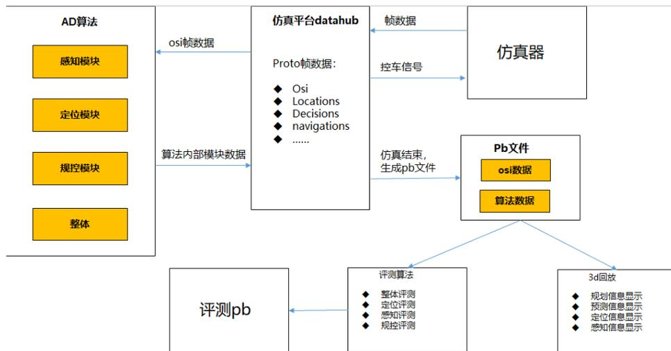
如上图所示，算法与仿真平台datahub通过grpc连接，通过接收osi数据作为输入，并将算法内部信号输出到datahub，仿真平台可以生成仿真的osi和算法pb，用于3d回放展示和算法的白盒化评测。
