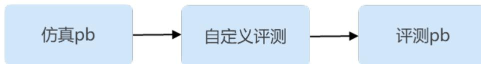
如上图所示，自定义评测算法以仿真pb文件作为输入，进行评测逻辑处理后，将评测结果写成评测pb。
