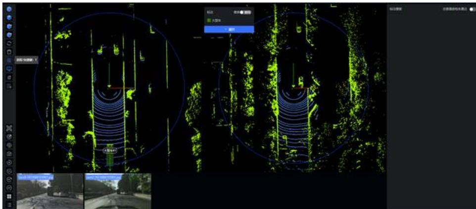
**步骤13** 调整点云框三视图，使其能完整包裹点云。
