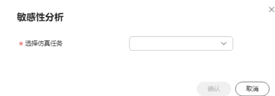
**步骤3** 单击“确定”，界面出现上次任务的敏感性分析结果，展示每个参数的灵敏度参数，该值的范围在[0,1]，该值越大，说明该参数的变化对评测分数的影响越大。
