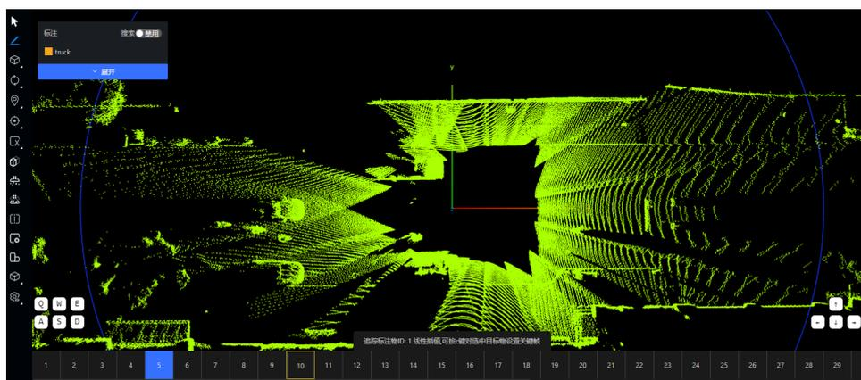
**步骤5** 选中同一个追踪对象（对象id相同）的标注框，如无该对象的标注框，则先使用标注框工具进行标注。
