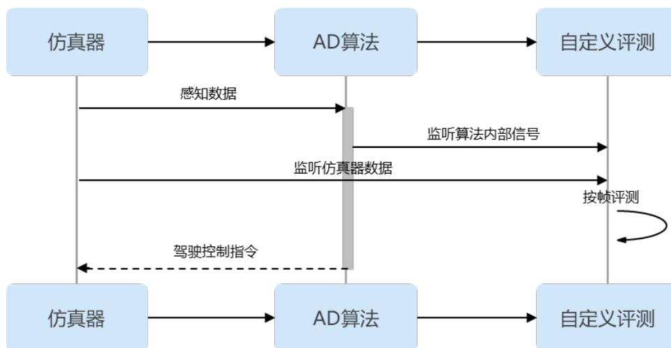
实时评测的基本架构如上图所示，实时评测算法从仿真器和AD算法按帧接收数据，每接收一帧数据，就调用一次评测函数，在最后仿真结束时将评测结果写成评测pb文件。
