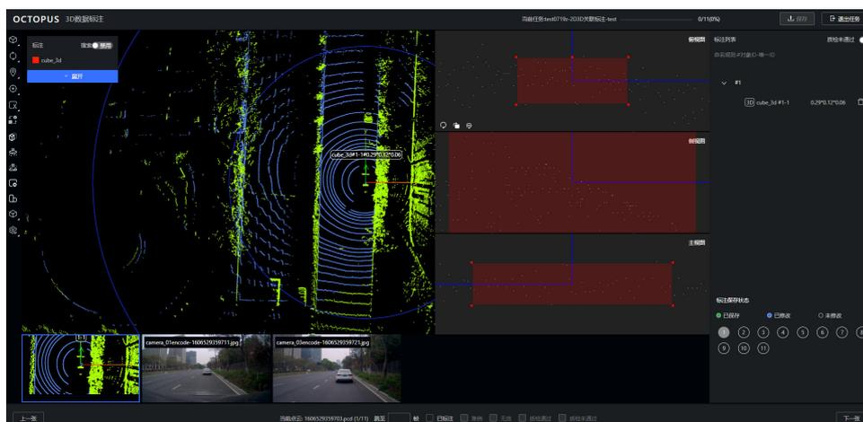
依据标注规范要求，结合下方真实图片中对应标注物大小，调整点云图像中标注物三视图中标注框。
